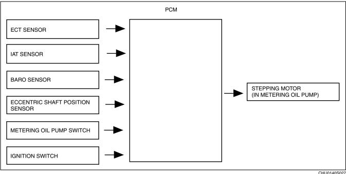
**METERING OIL PUMP CONTROL OPERATION**
